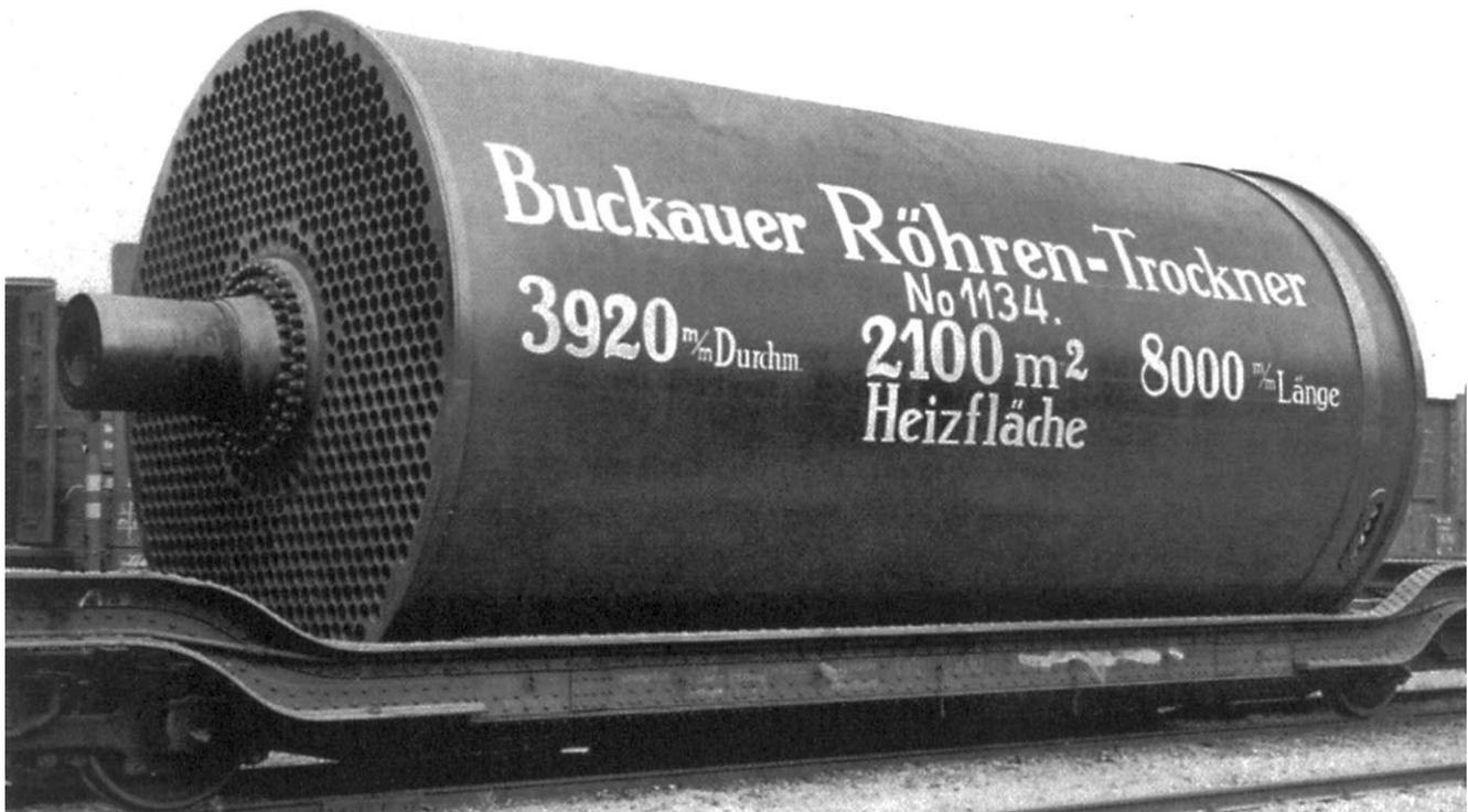
Abb. 27: Röhrentrockner der Maschinenfabrik Buckau, 1937
