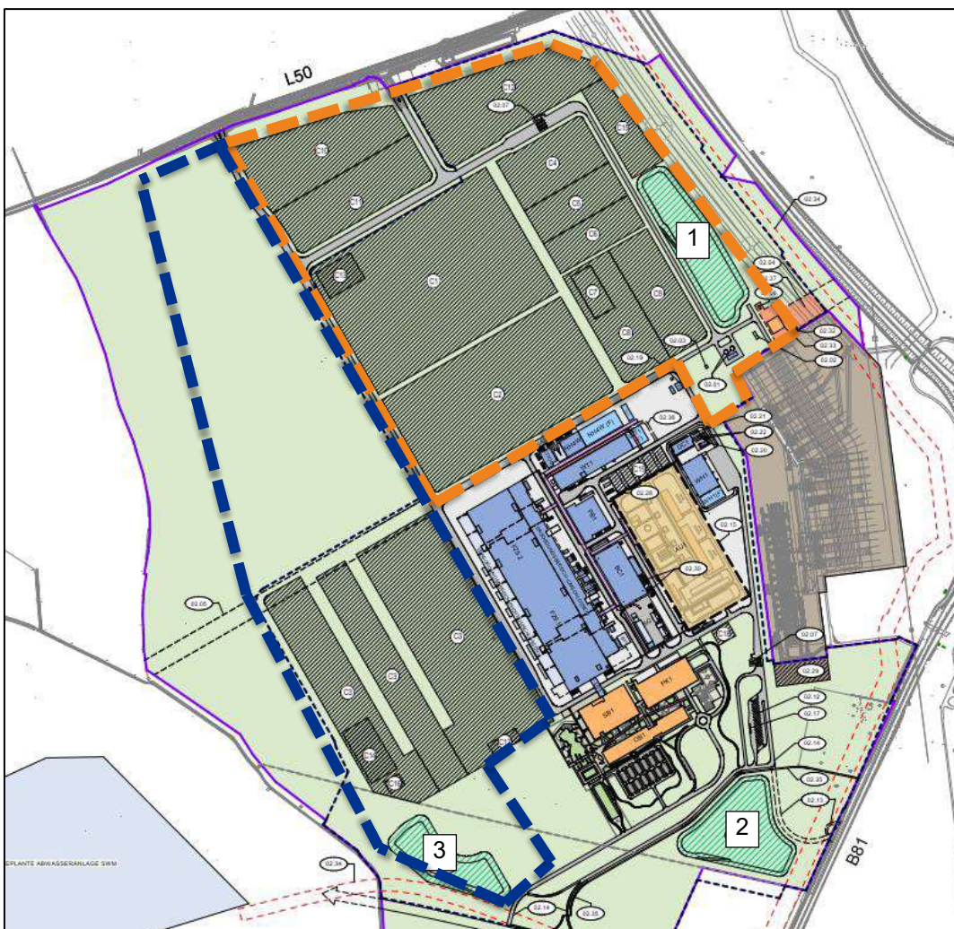
Abbildung 2-1: Layout des Standorts mit identifizierten Rückhaltebecken.
