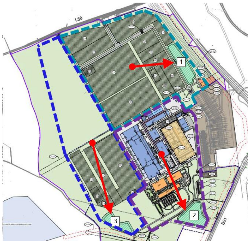
Abbildung 3: Angeschlossene Flächen Versickerungsbecken (4)
