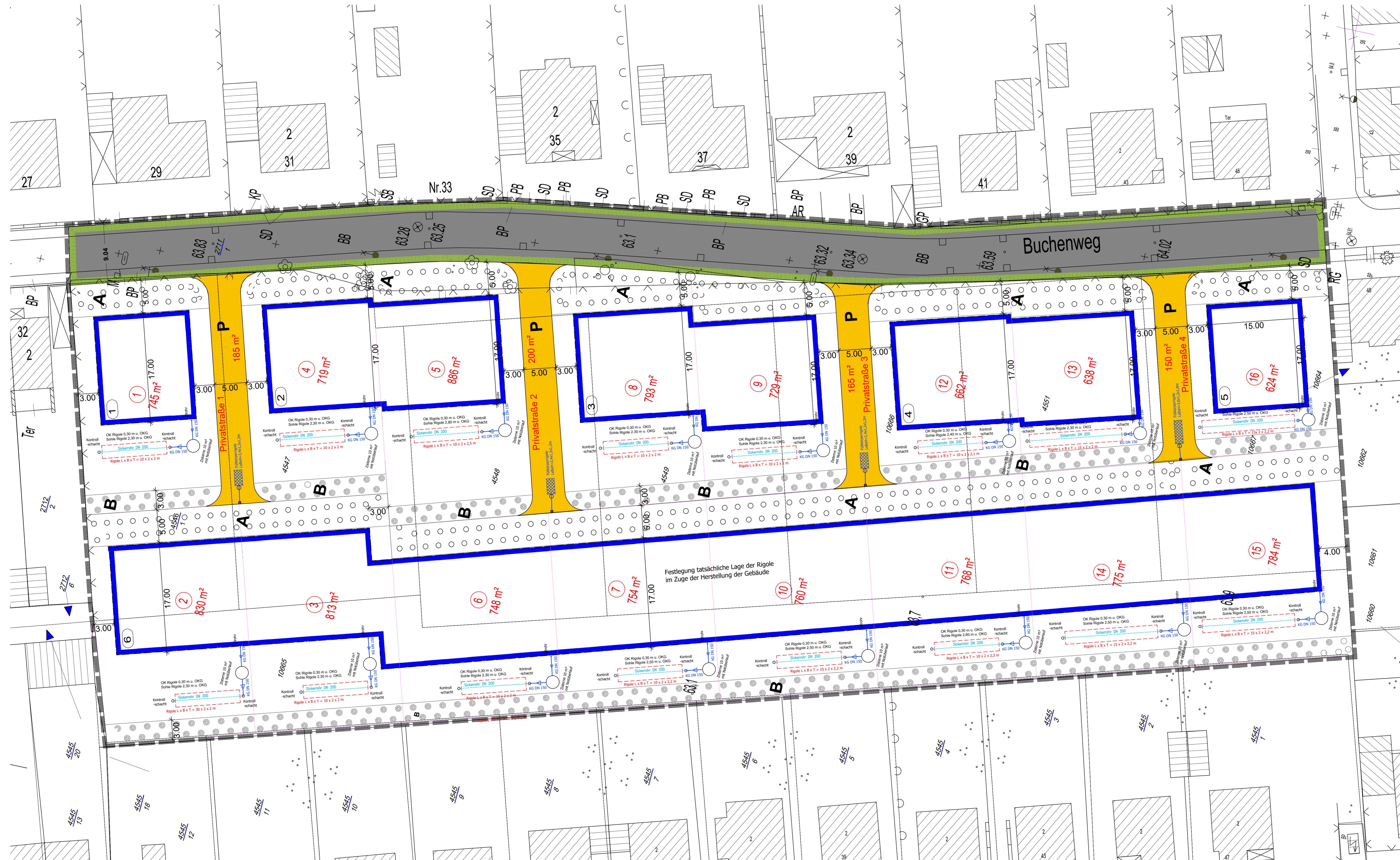
Festlegung tatsächliche Lage der Rigole im Zuge der Herstellung der Gebäude
