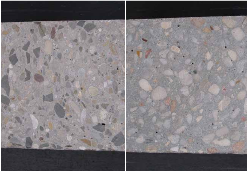
links: RC-Beton (trocken), rechts: Normalbeton (trocken) – sehr gut sichtbar die homogene Verteilung der Gesteinskörnungen
