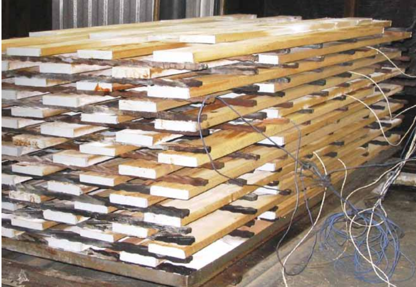
Stapel mit modifiziertem Kiefernholz nach der Aushärtung des Melaminharzes
