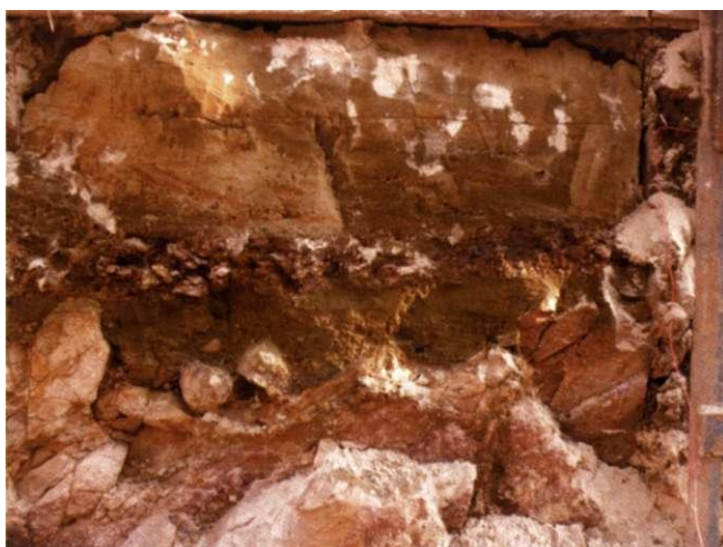
Abb. 7-3 und 7-4 Transgressionskonglomerat mit Felsgeröllen in einer Baugrubenwand am Magdeburger Universitätsplatz (Foto links und Baustellenskizze rechts)
