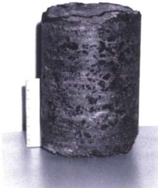
Abb. 6-9 Zechsteinkalk mit "Löchern" aus 40m Tiefe, Bohrung an der Sternbrücke
