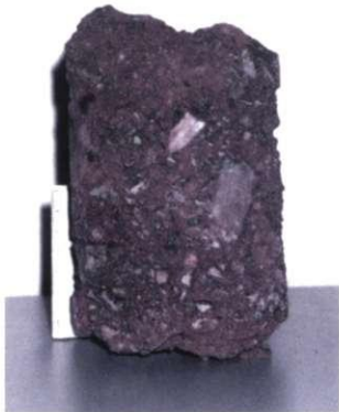
Abb. 6-7 Auslaugungsrückstand aus 30 m Tiefe. Bohrung an der Sternbrücke
