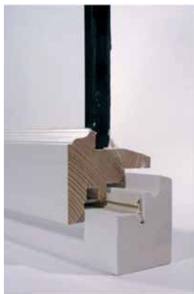
Abb. 42: Das Fenster als Kastenfenster, dabei wird die Wärmeschutzverglasung im Innenflügel ausgeführt. U-Wert: 1,10 W/m 2 K
