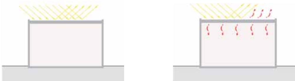
Abb. 13: Thermische Auswirkungen der Sonneneinstrahlung in Abhängigkeit von der Oberflächenfarbe helle Oberfläche (links); dunkle Oberfläche (rechts)
