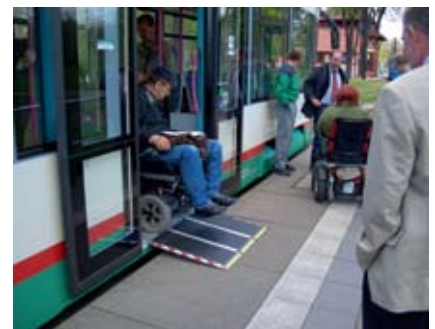
Straßenbahn mit mobiler fahrzeuggebundener Einstiegshilfe
