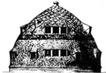
Abb. 45: September 1921. Parkwärterwohnhaus auf dem Gelände der MIAMA. Runde Wohnhäuser ergeben bei weniger Umfassungsmauer mehr Wohnfläche. In der Mitte war ein Ofen eingebaut. Die oberen Fenster dienen der Raumbelichtung, die unteren auch zum Hinaussehen. Im unteren Geschoss von 63 m 2 waren eine Wohn- und Schlafstube, ein Kinderzimmer, Küche und Bad vorgesehen; im oberen Geschoss von ca.40 m 2 eine Wohn- und eine Schlafstube, sowie ein Bodenraum.
