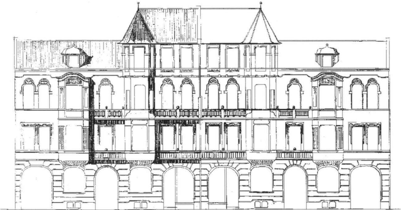
Abb. 122 Fassadenentwurf Westring 8 und 10, 1901; der Fassadendekor wurde in der Ausführung verändert; im Erdgeschoß dominieren die zahlreichen großen Öffnungen für die beiden Durchfahrten an den Außenseiten, die Eingangstüren und die Ladenfronten in der Mitte
