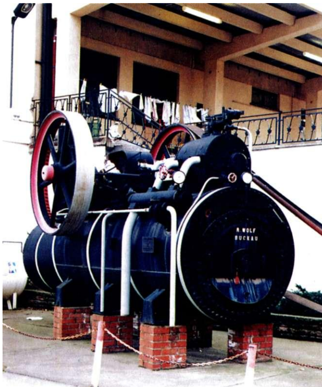
Abb. 54: Alte Dampflokobile der Firma R. Wolf auf dem Gelände Schönebecker Straße 82-84, Baujahr 1911, Leistung 180 PS. Die Maschine steht unter Denkmalschutz
